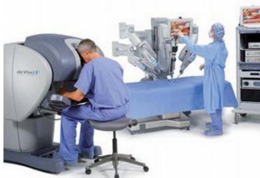
Obr. 2 – Robotický systém da Vinci® a jeho 3 komponenty (zleva: chirurgická ovládací konzole, operační konzole a torakoskopická videověž) zvětšit
